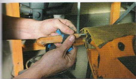
Finition d'un Office à manche en bois de fer.
