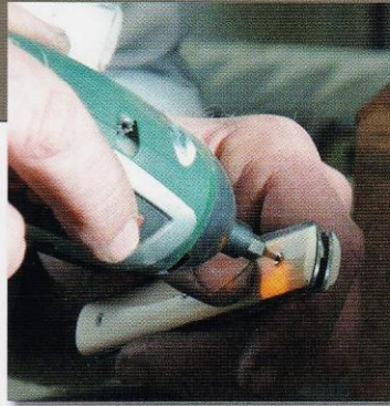
Ultimes opérations sur un Français à côtes en ivoire et lame signée Christian Moretti en acier de bas fourneau.
